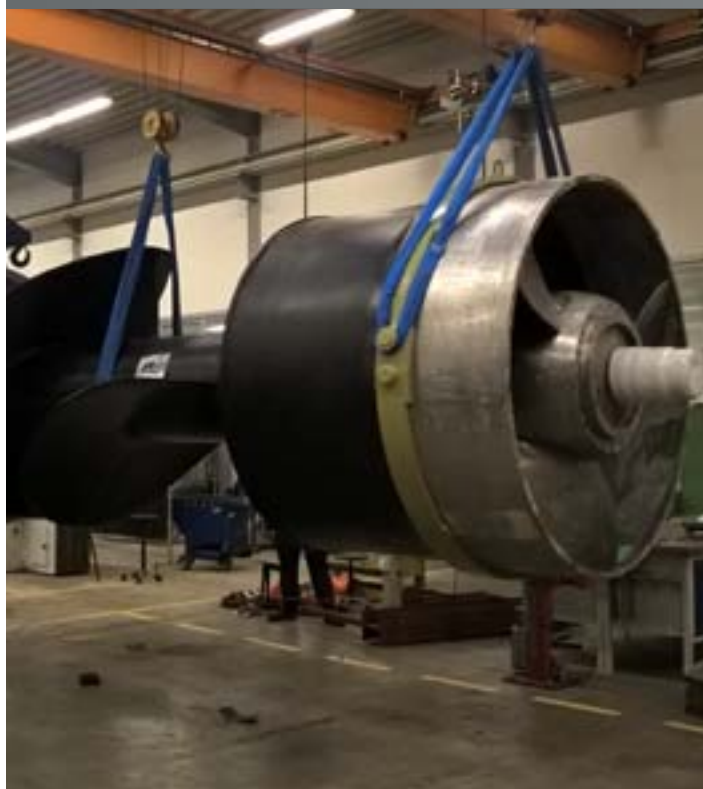
Grundinstandsetzung einer KSB-Pumpe
