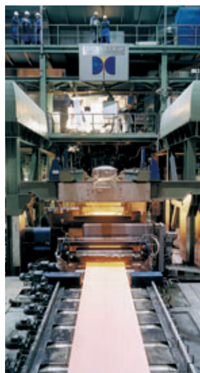
Blick in eine Bandgießanlage der Thyssen-Krupp Nirosta GmbH. Beim Bandgießen wird direkt aus geschmolzenem Metall breites, dünnes Edelstahlband hergestellt.
